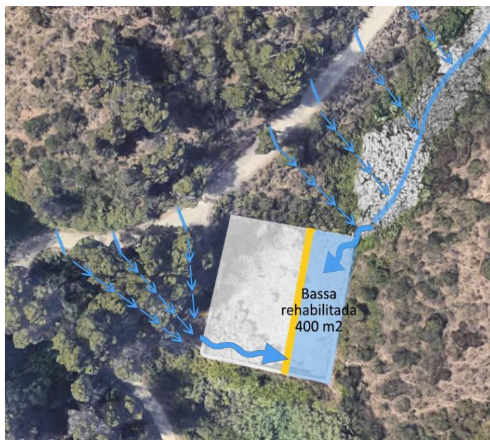
Esquema de recollida de l'aigua del camí (Ill. 6)
